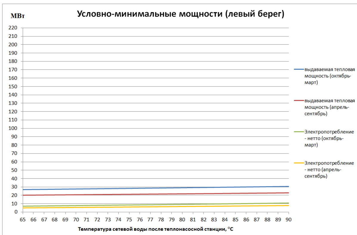
Рис. 5.3. Условно-минимальная тепловая мощность левобережной теплоснасосной станции
